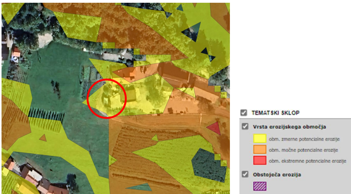
Slika 6: izsek iz študije erozijskih nevarnosti
