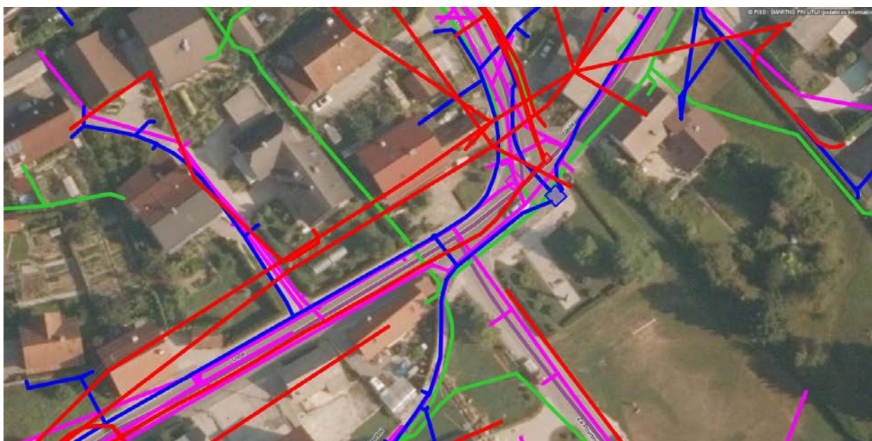
Slika 9: Prikaz obstoječih tras komunalnih vodov na obravnavanem območju (vir: PISO)
